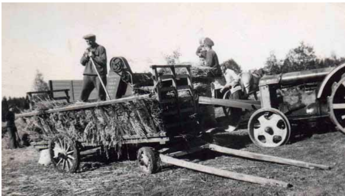
Tresking på Vestua Trosterud høsten 1946. Traktoren som driver treskeverket, har jernhjul, og er sannsynligvis en Fordson, og var den første traktoren på Flaten og Trosterud. Gudbrand Flaten står i høyvogna og legger kornbandene opp på brettet til Ole Tjernæs, som legger de i treskeverket. Anders Skogheim, til venstre, tar imot halmen. Gutten til venstre for Tjernæs er Hemming Ringsby, 4 år gammel. Mannen til høyre er ukjent. Bak står Blakka med kjerre og venter på kornsekkene som skal kjøres på bua. Foto: Ole Ringsby.
