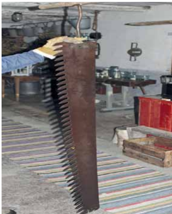
Issaga ble brukt til å skjære 50 – 60 cm tykk is til blokker for lagring i tykke sagflislag på Trandemsætra. Foto: Jørgen Dahl, 2012.
