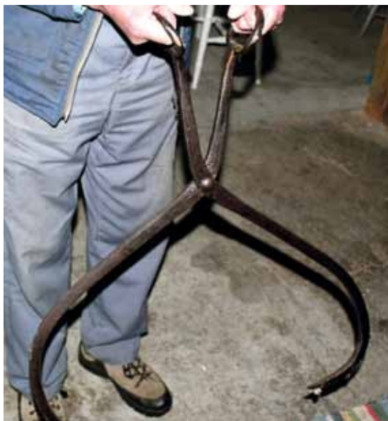
Saksa (tanga) ble brukt for å vippe de ferdige og glatte blokkene fra vannet og opp på isen. Der ble blokkene lastet opp på en stor kjelke og kjørt med hest til islageret på Trandemsætra. Foto: Jørgen Dahl, 2012.
