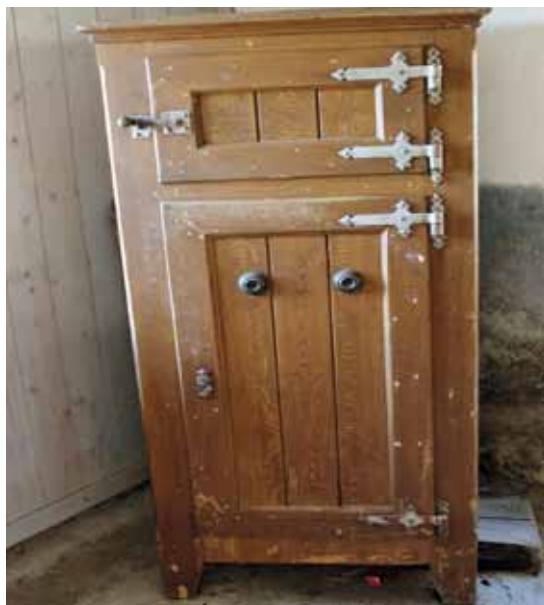
Isskap av ganske vanlig type. Øverst en liten dør foran det lille rommet hvor isblokken ble lagt. Døren under fører til det egentlige kjølerommet i skapet. Her sildret smeltevannet fra isblokken ned på veggene og skapte lav temperatur i rommet slik at maten kunne oppbevares der over lengre tid. Foto: Jørgen Dahl, 2012.
