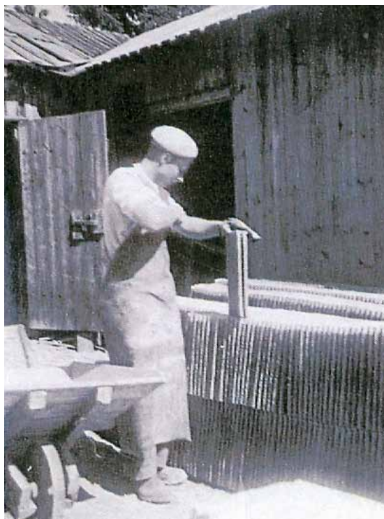
Asbjørn Holmedal, født 1927, i gang med å støype takstein. Eier: Asbjørn Holmedal.
