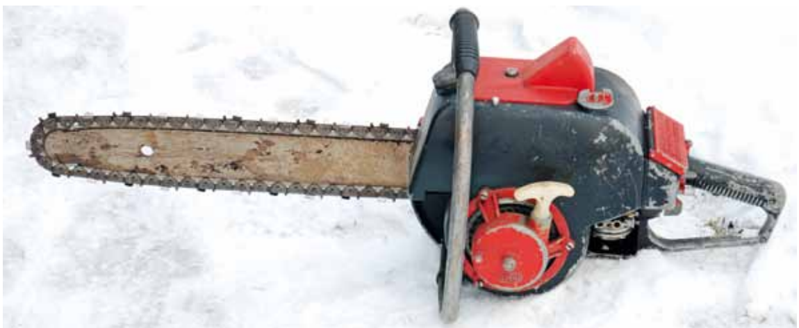
Jobu Tiger var den første motorsaga for mange skogsarbeidere. Angivelig veide den 10,4 kg, men egentlig ca 12 kg. Den var tung og lite egnet til annet enn felling og kapping. Utover på 1960-tallet ble det laget lettere og mer anvendelige sager til felling og kvisting. Eier av denne saga er Jørgen Dahl. Foto: Finn Wahl, 2010.
