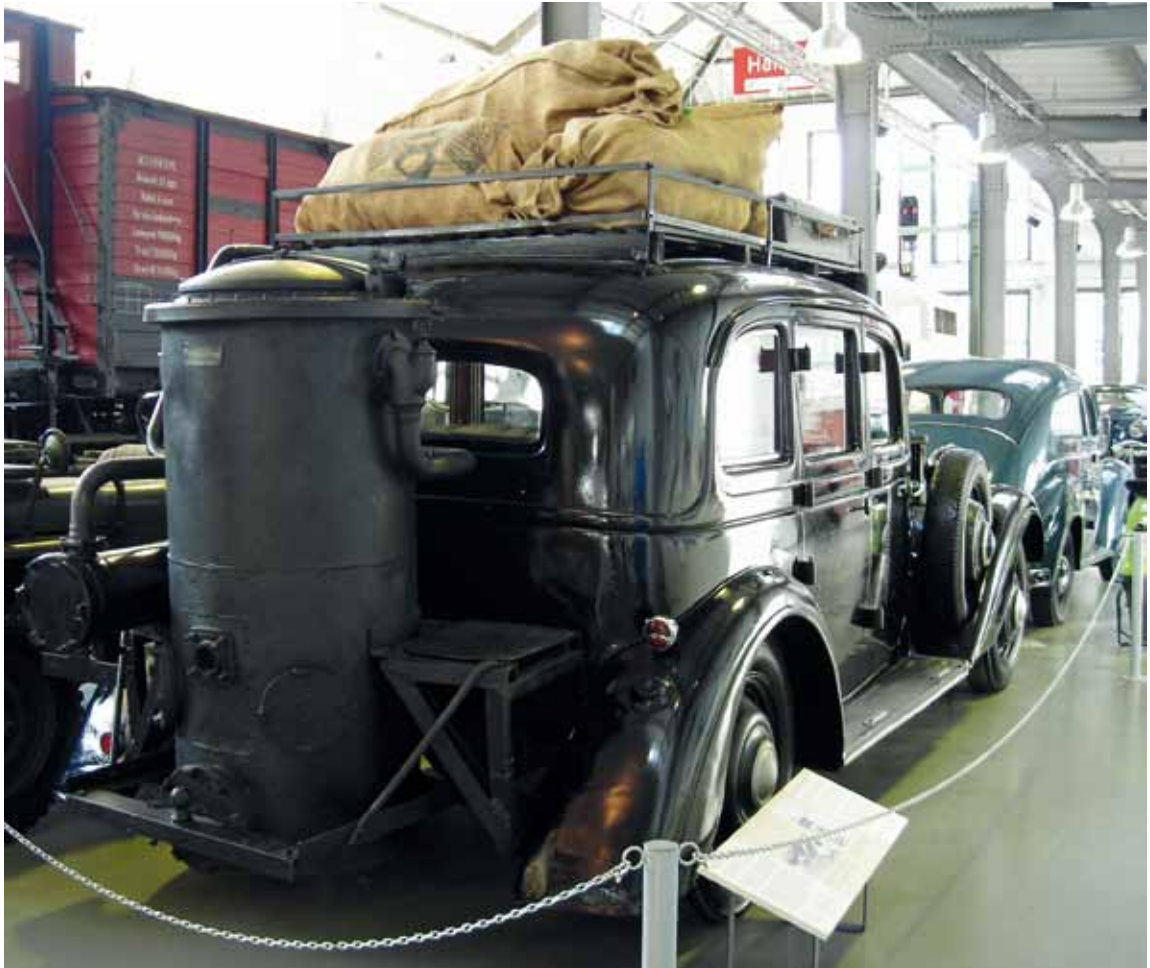
Adler med vedgassgenerator, også kalt knottgenerator. Den ble brukt blant annet under 2. verdenskrig da det var mangel på bensin. En knottgenerator er en slags ovn hvor brensel bare delvis forbrennes, idet det samtidig omformes til brennbar gass. Brensel var knott, små vedstykker 6-8 cm lange, helst av or. 2,5 kg knott tilsvarte ca. 1 liter bensin. Trekkraften ble redusert, og det kunne føre til store problemer i motbakker. Girspaken måtte brukes flittig. Foto: Adler katalog.
