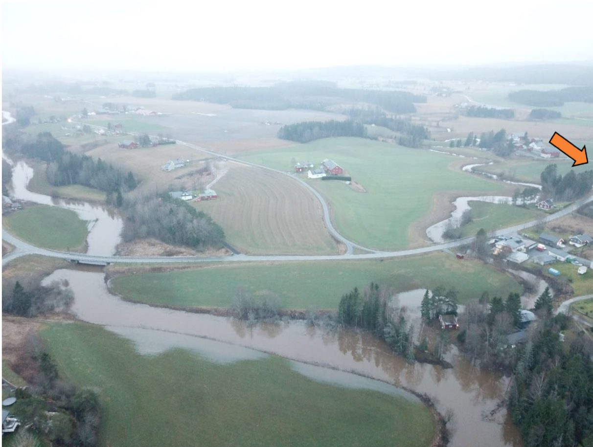
Figur 4: Dronebilde av samløpet til Prestelva (til høyre) og Hølandselva sett sørover. Bildet er tatt under flom i desember 2020, og illustrerer Hølandselvas innvirkning på vannføringen i Prestelva. Planområdet er rett utenfor bildet ved den oransje pila.
