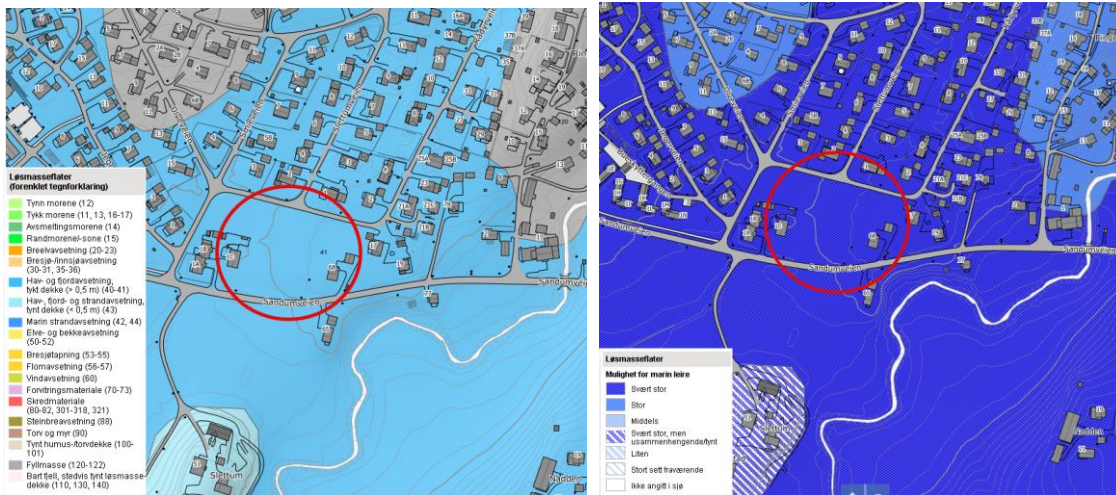
Figur 3: Utsnitt hentet fra NGU sitt kartverk. Figur til venstre viser løsmasseflater innenfor tomten. Figur til høyre viser mulighet for marin leire. Kilde: NGU.no.
