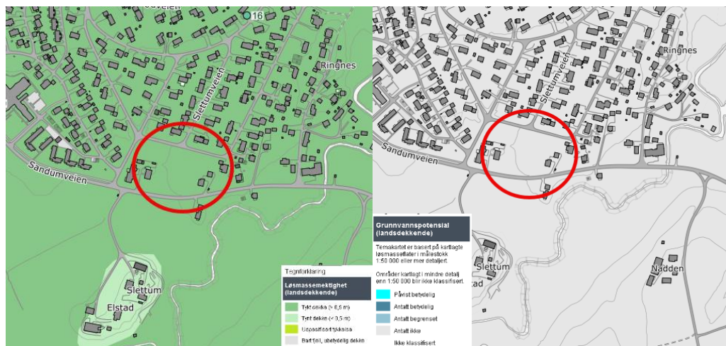
Figur 4: Utsnitt hentet fra NGU sitt kartverk. Figur til venstre viser løsmassemektigheten, og figur til høyre viser grunnvannspotensialet. Kilde: NGU.no
