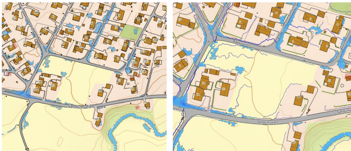
Figur 8: Bilde til venstre viser utsnitt av tomten ved et 15 cm nedbør og bildet til høyre viser tomtens dreneringslinjer/avrenning ved samme nedbørstilfelle. Kilde: Scalgo.
