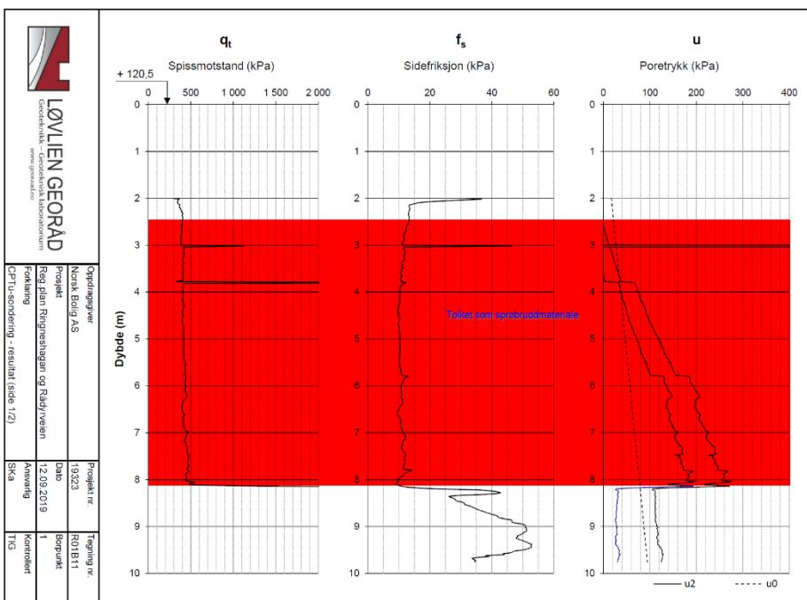
Figur 1.2 Totalsondering og CPTU-sondering fra borpunkt 1. Rød skravur markerer tolket forekomst av sprøbruddsmateriale / kvikkleire
