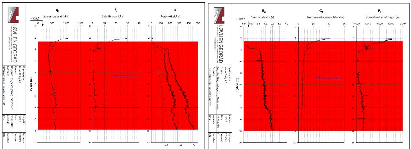
Figur 1.7 Totalsondering, CPTU-sondering og prøveserie fra borpunkt 9. Rød skravur markerer tolket forekomst av sprøbruddsmateriale / kvikkleire
