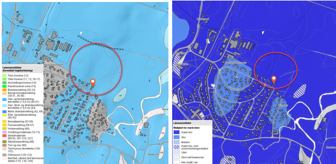
Figur 3: Utsnitt hentet fra NGU sitt kartverk. Figur til venstre viser løsmasseflater innenfor tomten. Figur til høyre viser mulighet for marin leire. Kilde: NGU.no.
