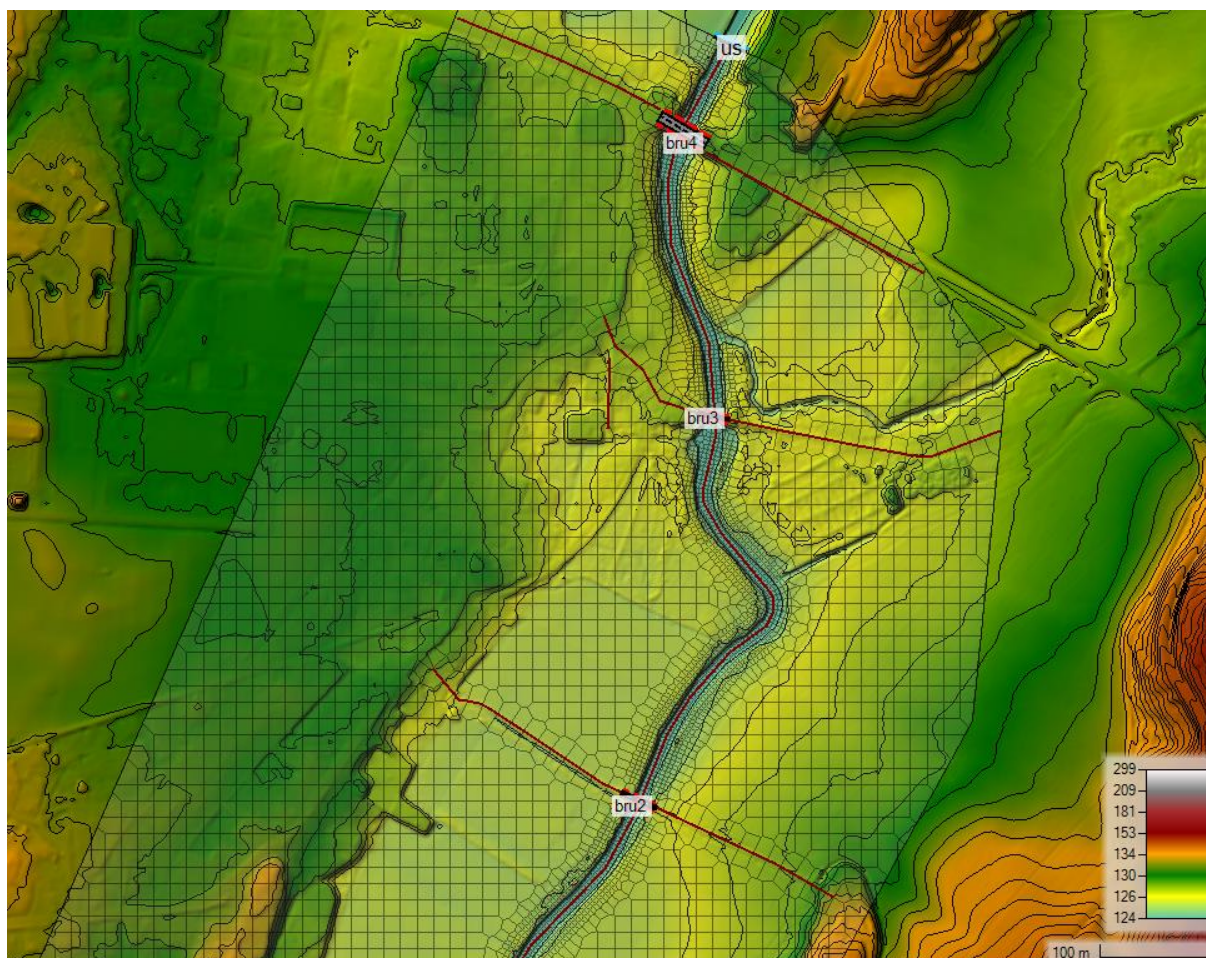
Figur 11: Illustrasjon av terrengmodell, beregningsgrid og plassering av grensebetingelse ved kartleggingsområdet.
